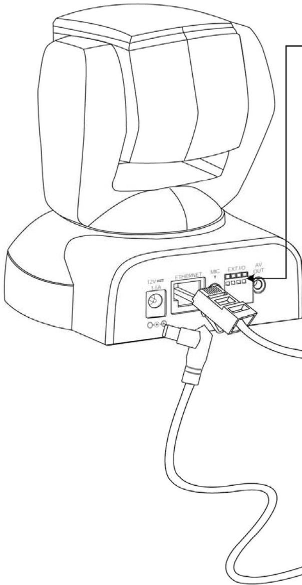
1. もし、センサやアラームのような外部機器を利用する時は、I/O ターミナルブロックへ接続します。
